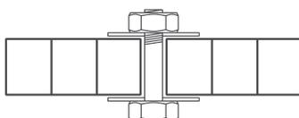
При креплении панелей винтовым соединением или саморезом диаметр отверстия должен быть на 2 мм больше диаметра винта или самореза. Не перетягивать винты, оставляя зазор на свободный ход.
