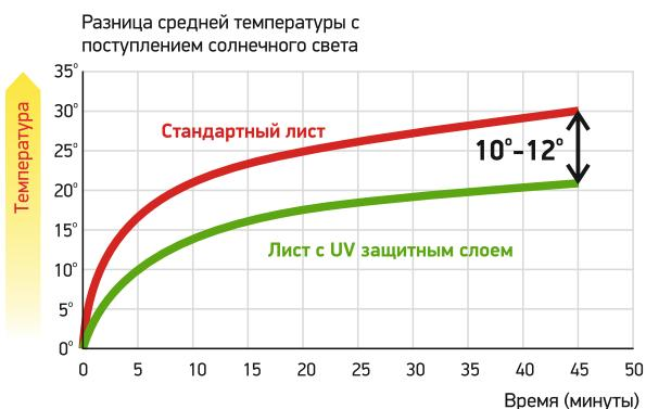
Основываясь на тестировании конструкций, построенных из листов сотового поликарбоната с UV защитным слоем, можно сделать вывод, что расходы энергии на внутреннее отопление помещений может быть снижено примерно на 10-12°C.
