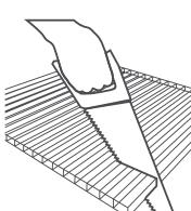
Листы можно легко и точно резать стандартным оборудованием (циркулярная пила, ручная пила или слесарная ножовка). Защитная пленка при резке должна оставаться на листах. Опилки следует выдувать из каналов сжатым воздухом.
