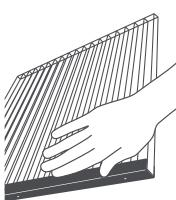
Нижний торец следует закрывать перфорированной лентой, защищающей соты от попадания грязи и пыли.
