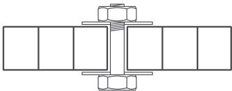
При креплении панелей винтовым соединением или саморезом диаметр отверстия должен быть на 2 мм больше диаметра винта или самореза.
