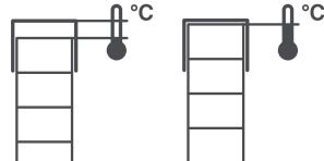
При монтаже следует учесть термическое расширение 2-3 мм на погонный метр для прозрачного материала и 3-4 мм для цветного.
