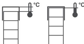
При монтаже следует учесть термическое расширение 2-3 мм на погонный метр для прозрачного материала и 3-4 мм для цветного.
