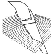
Листы можно легко и точно резать стандартным оборудованием (циркулярная пила, ручная пила или слесарная ножовка). Защитная пленка при резке должна оставаться на листах. Опилки следует выдувать из каналов сжатым воздухом.
